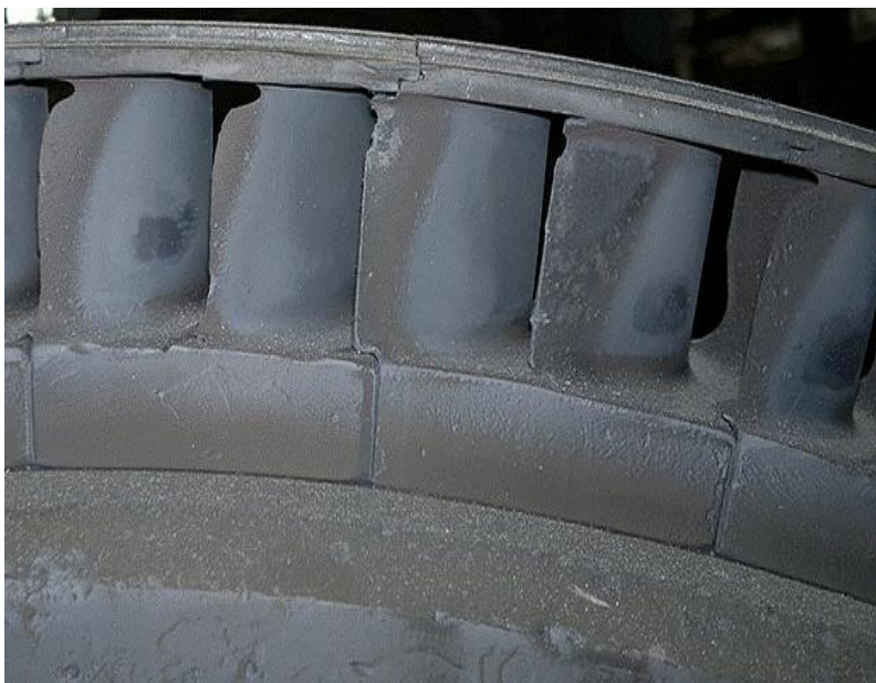
Эрозионный износ рабочих лопаток регулирующей ступени РВД (ТА К-200(215)-130-1М1, 205 МВт)
